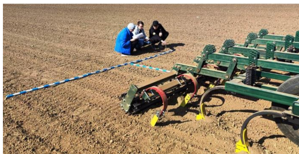
Рисунок 5 – Определение глубины обработки почвы методом поперечного и продольного профилирования
