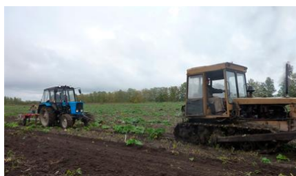
Рисунок 3 – Определение тягового сопротивления комбинированного почвообрабатывающего агрегата КППМ-2.7 методом буксирования
