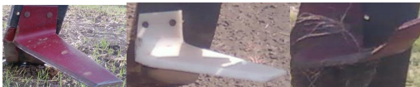
а) плоскорезный б) полимерный плоскорезный в) криволинейный рыхлители
