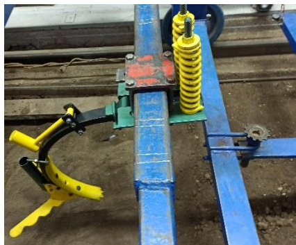
Рисунок 4 – Рабочий орган культиватора
