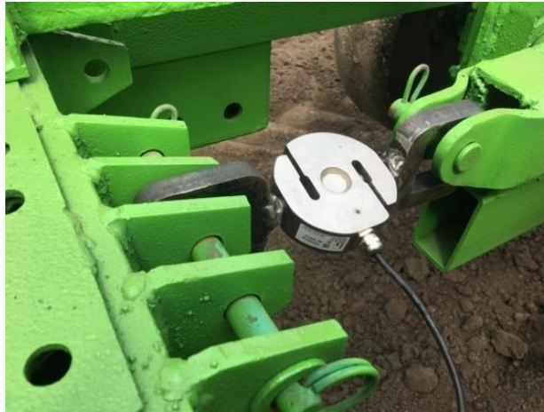
Рисунок 3 – Тензодатчик силы растяжения и сжатия ТЕНЗО–М С2Н–2–С3
