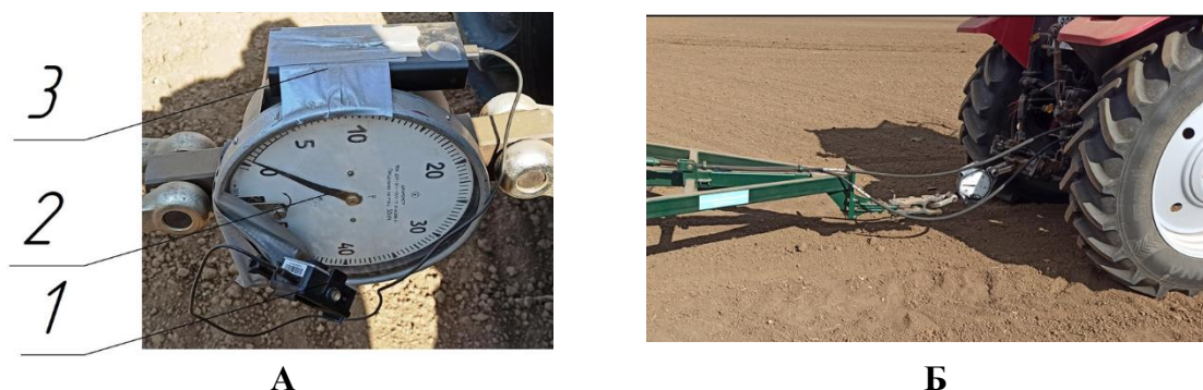
Рисунок 3 – Устройство для регистрации экспериментальных значений тягового сопротивления агрегата
