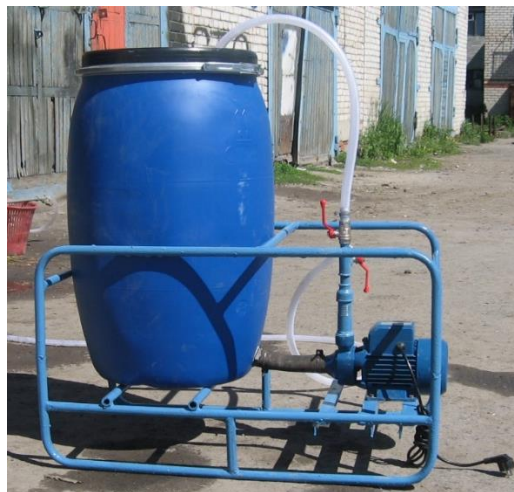
Рисунок 3 – Насос вихревой с емкостью для рабочих растворов (эмульсий), установленный на трубчатой раме
