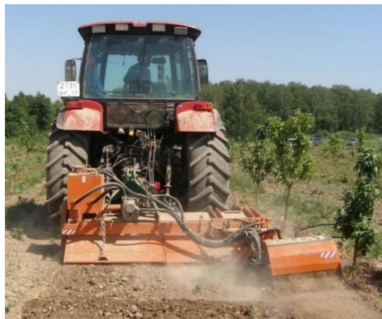
Рисунок 7 – Макетный образец фрезы садовой с выносной фрезерной секцией в работе
