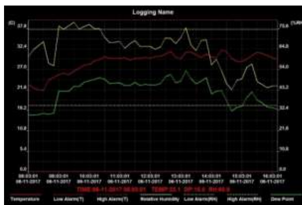
Рисунок 4 – Данные записи параметров (температуры и влажности) сушки лепестков розы прибором DVM-171TND (Крымская опытная станция садоводства, 11.06.2017 г.)
