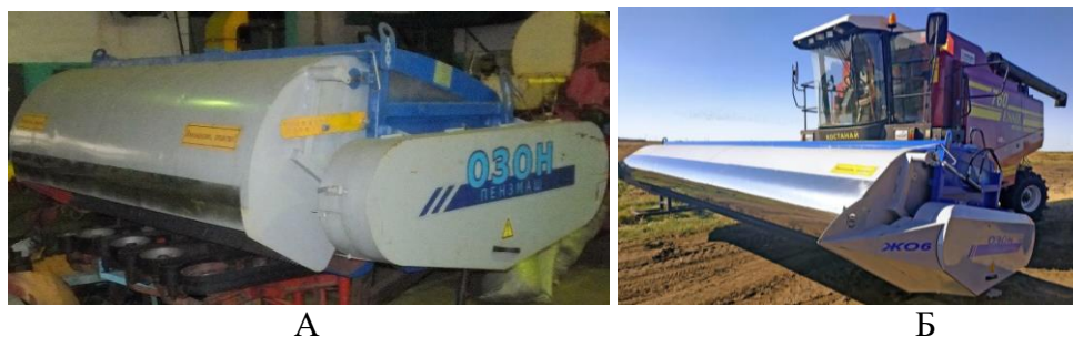
Рисунок 3 – Общий вид очесывающей жатки «ОЗОН» (А) и в агрегате с зерноуборочным комбайном (Б)
