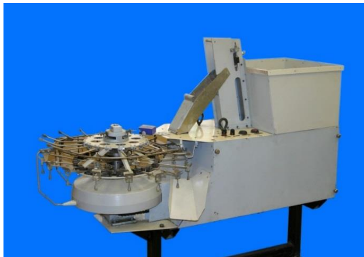
Рисунок 7 – Модернизированный автомат для деления коконов по полу
