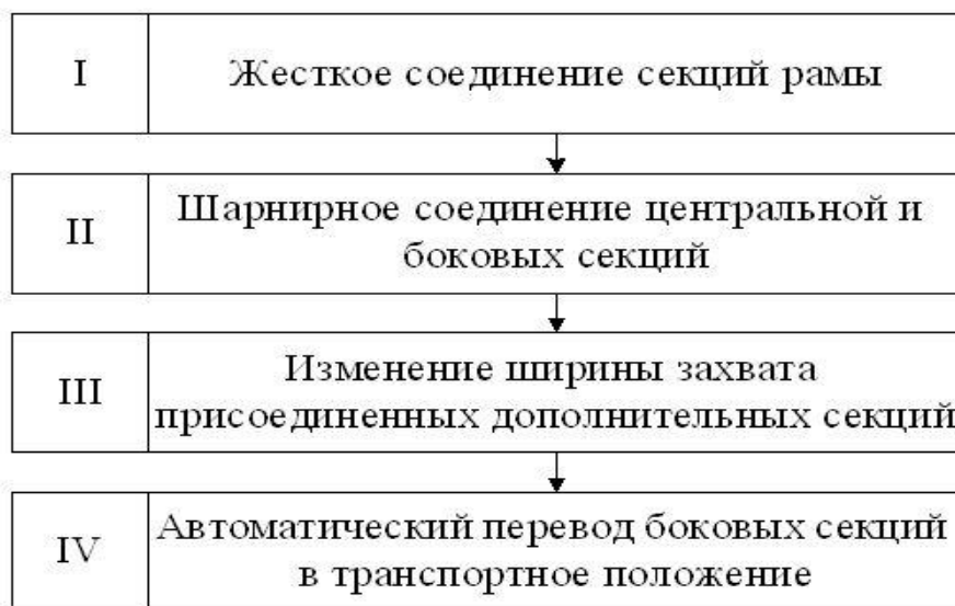
Рисунок 1 – Основные тенденции развития конструкции сцепных устройств для многосекционного агрегатирования посевных машин
